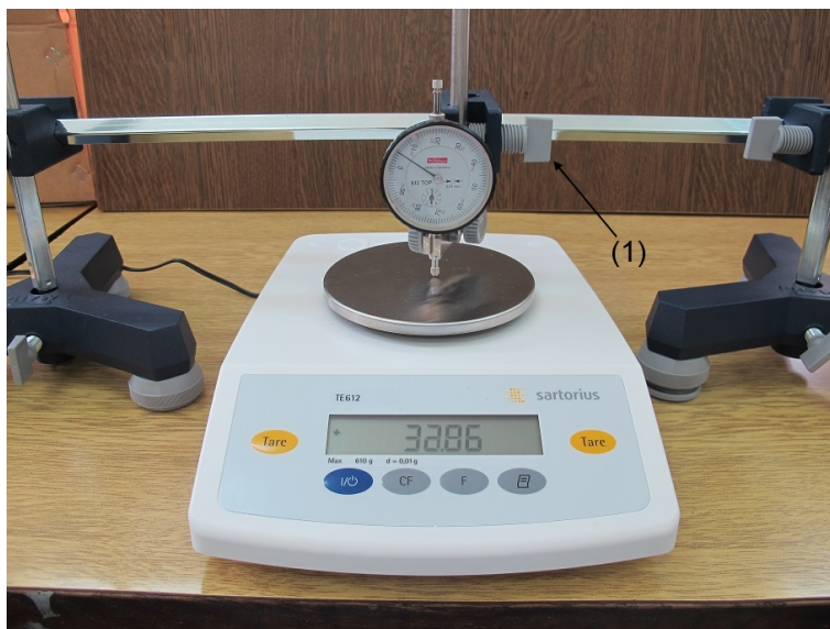
Slika 5.5 Kalibracija komparatora uz pomoć digitalne vage. (1) - zavrtnj za podešavanje visine komparatora.
