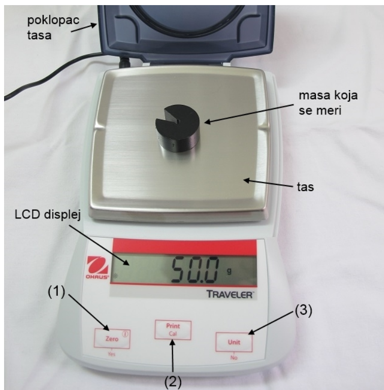
Slika 2.6 Digitalna vaga opsega 0-3000 g; tačnost 0,1 g; rezolucija 0,1 g. (1) - kratak pritisak : ako je isključena, vaga se uključuje; ako je vaga uključena skala se postavlja na nulu (tj tarira ako je vaga opterećena).
