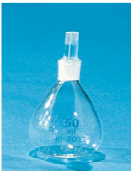
Slika 3.1 Piknometar (levo) i gustina destilisane vode na normalnom pritisku u funkciji temperature (desno).
