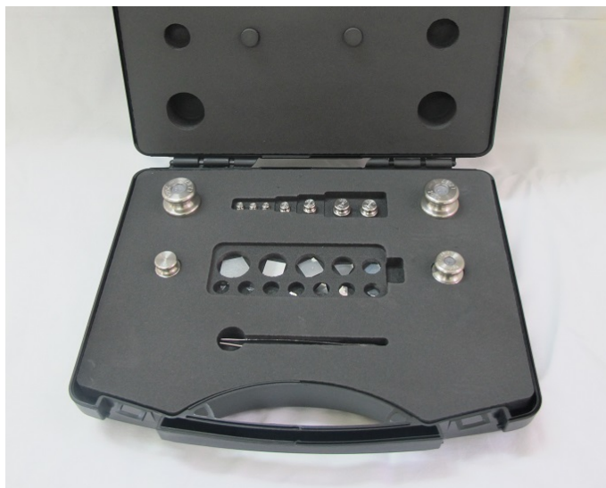
Slika 2.2 Komplet tegova sa pincetom za terazije; najveći teg je mase 200 g, a najmanji 1 mg.
