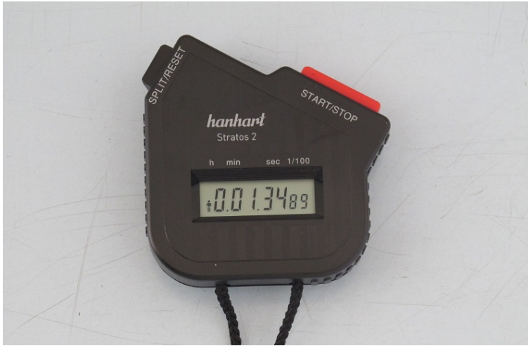
Slika 1.15 Digitalni hronometar; pokazuje 1 min i 34,89 s=94,89s. Opseg: 10 h. Tačnost: 0,01 s. Rezolucija: 0,01 s.
