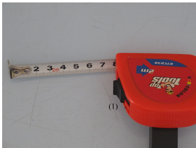
Slika 1.1 Metarska traka. (1) je kočnica; njenim potiskivanjem ka metarskoj traci se traka fiksira u trenutnom položaju, a u suprotnom se oslobadja, tj može da se uvlači i izvlači.
