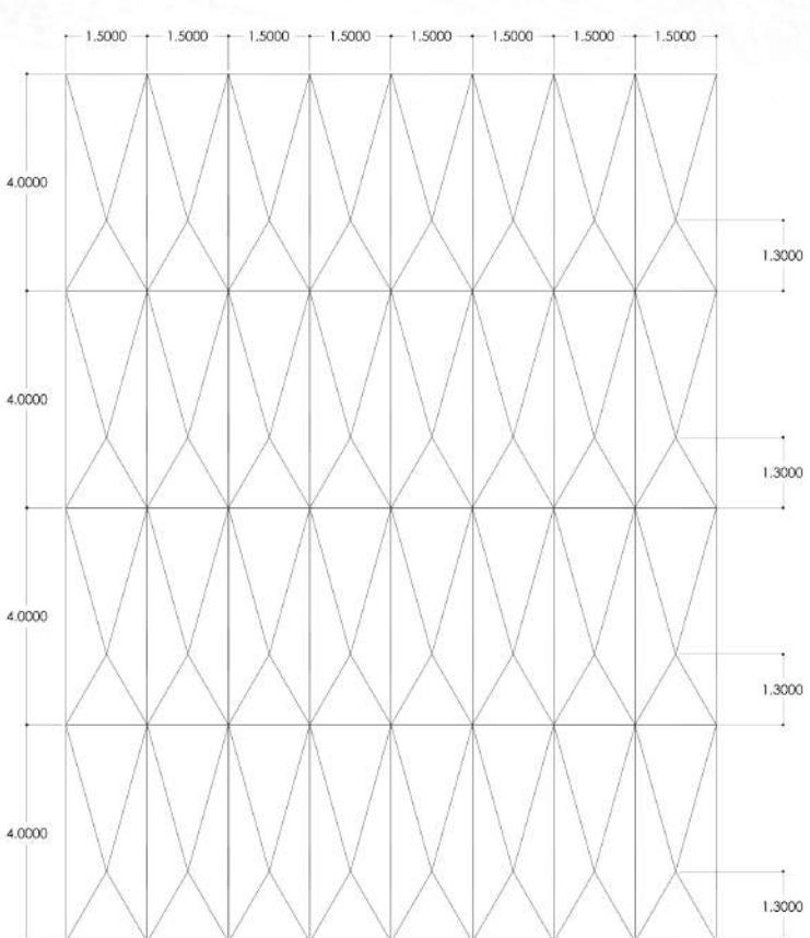
Schuco parametrijski sistem koristi fleksibilne geometrijske principe u nekoliko osnovnih geometrijskih modula. Data definicija predstavlja definiciju parametrizovane fasade na bazi Schuco parametarskog fasadnog sistema.
