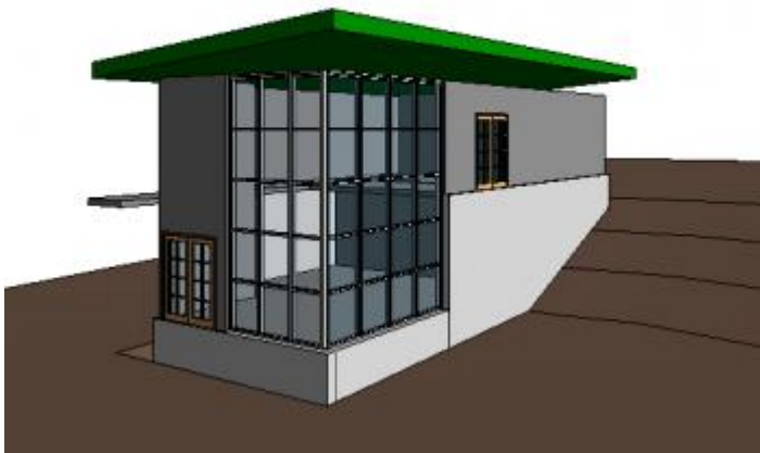
Slika 72 Objekat sa zid-zavesom
