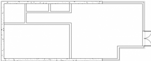
Slika 51 Spoljna vrata ubačena na nivo sutereana, 01 Lower Level.
