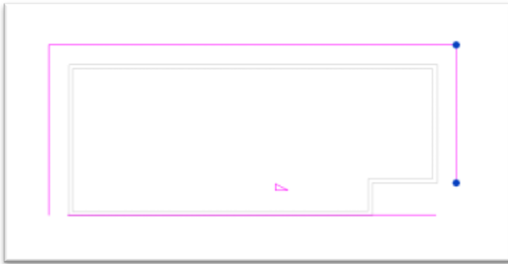
Slika 33 Crtanje karakterističnih linija krova
