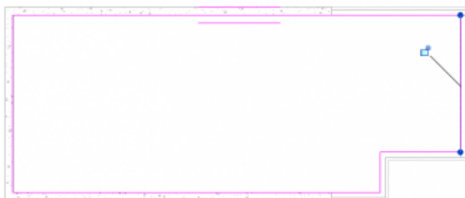
Slika 38 Modeliranje ploče korišćenjem Pick metode, odnosno izborom konturnih linija
