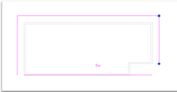
Slika 33 Crtanje karakterističnih linija krova
