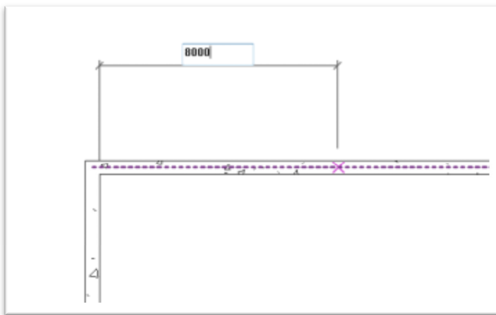
Slika 44 Odmeravanje tačke udaljene 800 cm od zapadnog zida
