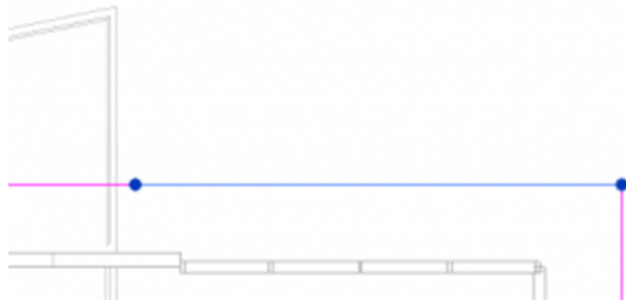
Slika 99 Prvi korak u modifikaciji konture krova
